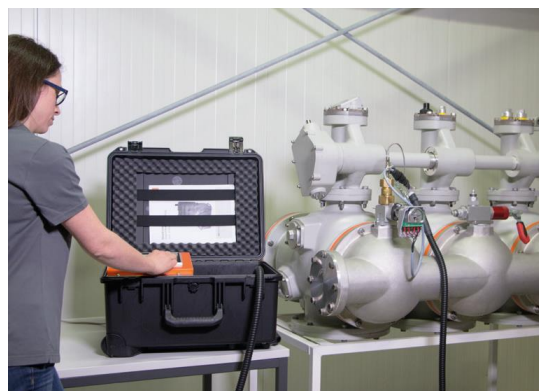
W połączeniu z specjalnym zaworem odcinającym urządzenie DensiControl IN pozwala sprawdzać gęstościomierze zamontowane bezpośrednio na przedziale gazowym
